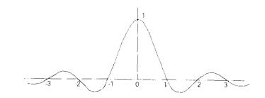
(a) THE WAVEFORM OF COSINE ROLL-OFF SPECTRUM (ROLL-OFF 30%)
