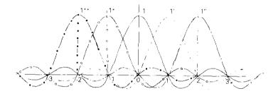
(b) SUPERPOSITION OF ABOVE WAVEFORM WITH NO ZERO-CROSSING ERROR
